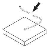
Com a rede elétrica desligada, ligue os cabos da luminária e isole com fita isolante anti-chamas
